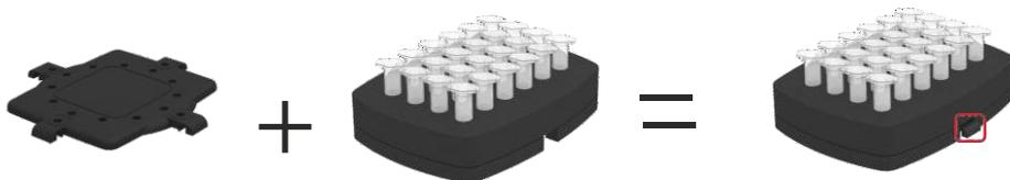
注：24管泡沫附件最大转速700转/分，填充量不超过样品的75%，不要在泡沫附件中的管道填充，液体泄漏可能会损害附件或装置
